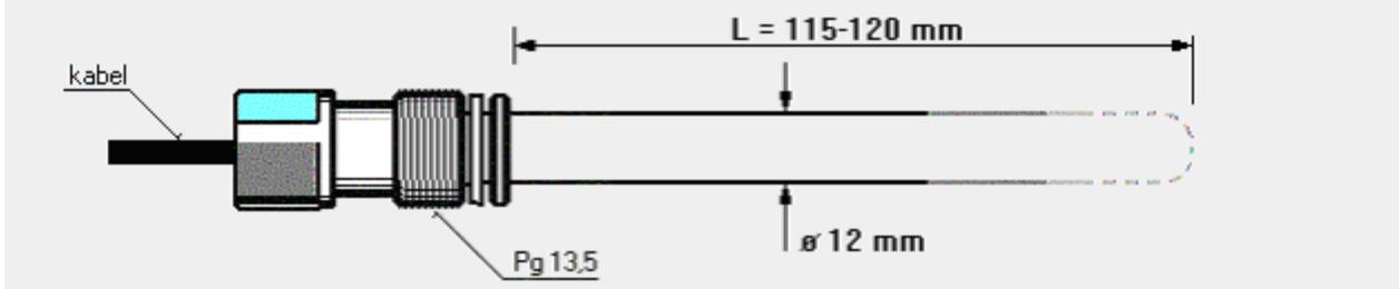
3. provedení s čepičkou S7 (na hlavě závit Pg 13,5 (P 13,5) – značení „-SP“
