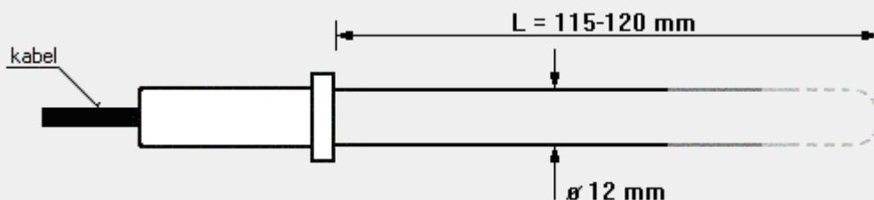
2. provedení se závitem Pg 13,5 (P 13,5) a vyvedeným kabelem – značení „-SK“
