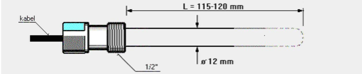
5. provedení „-C“ do tyčových snímačů řady STU 453 (elektroda se našroubuje vodotěsně čelně přímo do snímače, bez rozebírání snímače)
