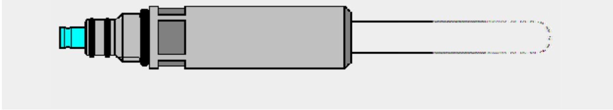
6. provedení v různých délkách se závitem  $\frac{1}{2}$ " a vyvedeným kabelem – značení „-G1/2/délka od čepičky dolů v mm“
